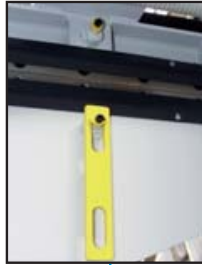
Chiavistello per bloccaggio piani in fase di manutenzione Safety lock Verriegelungshaken für die Heizplatte bei Wartungsarbeiten
