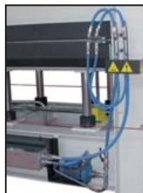
Impianto di riscaldamento Heating system Heizkreisanschlüsse
