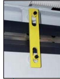
Chiavistello per bloccaggio piani in fase di manutenzione Safety lock Verriegelungshaken für die Heizplatte bei Wartungsarbeiten
