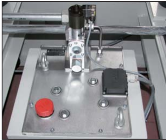
Pompa doppia con valvola disgiuntiva Two stage pump with pressure relief valve doppelte Pumpe mit Druckentlastungs-Ventil
